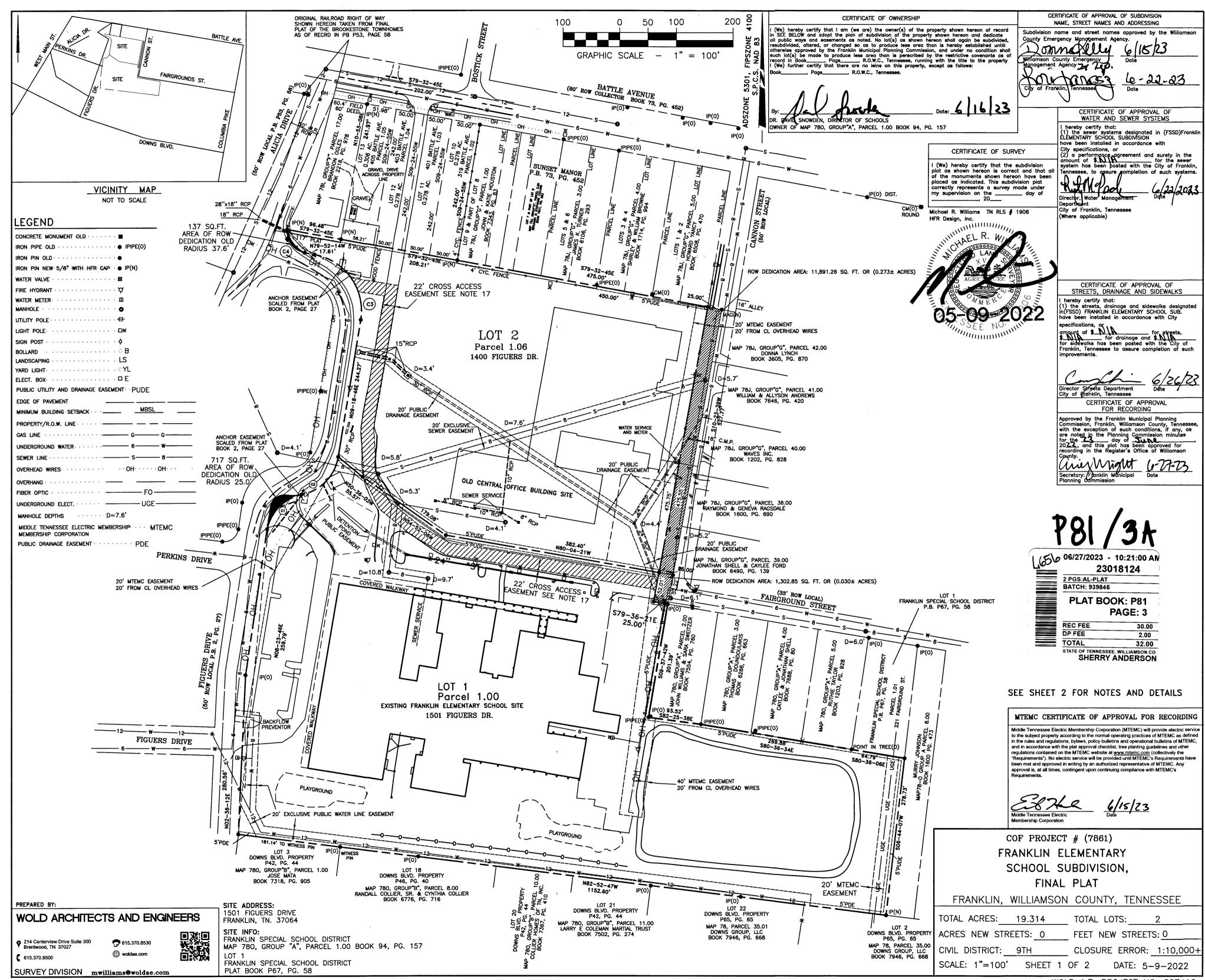
LEGEND CONCRETE MONUMENT OLD . . . . . . . . . IRON PIPE OLD · · · · · · · · · • IPIPE(0) IRON PIN OLD · · · · · · · · · · · · · · · · · IRON PIN NEW 5/8" WITH HFR CAP . . IP(N) UTILITY POLE · · · · · · · · · · · · · · · · ANDSCAPING . . . . . . . . . . . . LS PUBLIC UTILITY AND DRAINAGE EASEMENT - PUDE MINIMUM BUILDING SETBACK . . . . MBSL PROPERTY/R.O.W. LINE · · · · · · · · UNDERGROUND WATER . . . . . . . 6"-OVERHEAD WIRES . . . . . . . . OH
